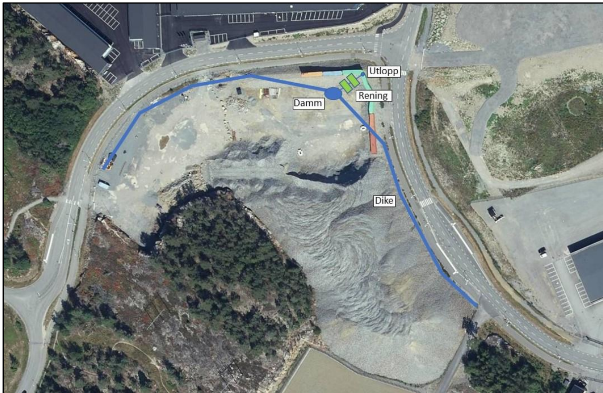
Karta 2. Schematisk skiss över det planerade dikessystemet med tillhörande damm och reningslösning.
