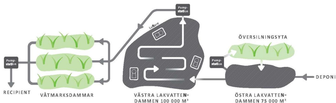
Figur 1.3 Lakvattenreningsystemet vid Gärstad avfallsanläggning.
